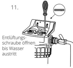
Entlüftungsschraube öffnen bis Wasser austritt
